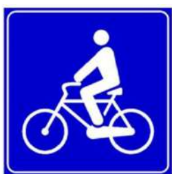
Figura II 324 art. 135 Attraversamento ciclabile
